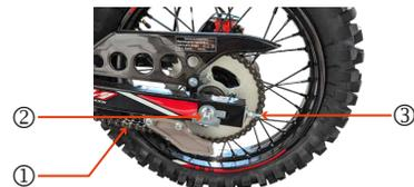
**Lubricación de la cadena de transmisión.** Retire la abrazadera de la cadena y saque la cadena, verifique el desgaste, si está dañada, debe cambiarse, la cadena polvorienta debe limpiarse y luego lubricar con lubricante para cadenas o aceite de motor periódicamente.
